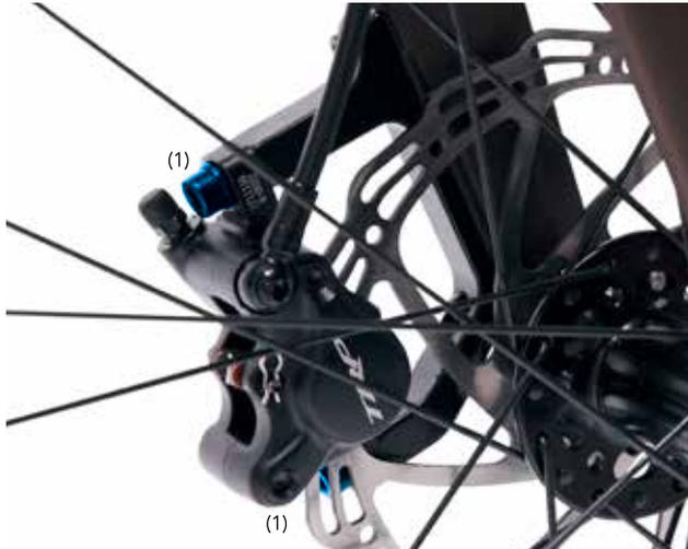
Nun kannst du den Bremssattel so ausrichten, dass die Bremsscheibe mittig von beiden Bremsbelägen läuft und keinen Kontakt zu beiden Belägen hat. Beim Festschrauben solltest du darauf achten, dass sich der Bremssattel nicht wieder verschiebt.
