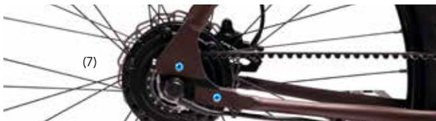
Das Hinterrad bewegt sich näher zur linken Kettenstrebe, wenn du die Riemenspanner-Schraube auf der linken Seite weiter einschraubst, oder auf der rechten Seite etwas löst und umgekehrt. Ist das Hinterrad wieder mittig ausgerichtet, musst du wieder die vier Schrauben der Sliderplates mit entsprechendem Anzugsdrehmoment (s. Kapitel Anzugsdrehmomente) fest schrauben.
